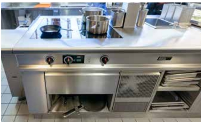
La technologie «Celsius Class» de la maison Menu System AG: le régulateur multimode garantit un contrôle précis des températures sans écarts alors que le pied à induction Star est équipé d'un système de refroidissement autonome permettant de garantir une puissance de chauffe illimitée des générateurs d'induction.
